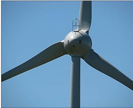
Figuur 5 : Windrichtingsmeter grootschalige windturbine horizontale as
