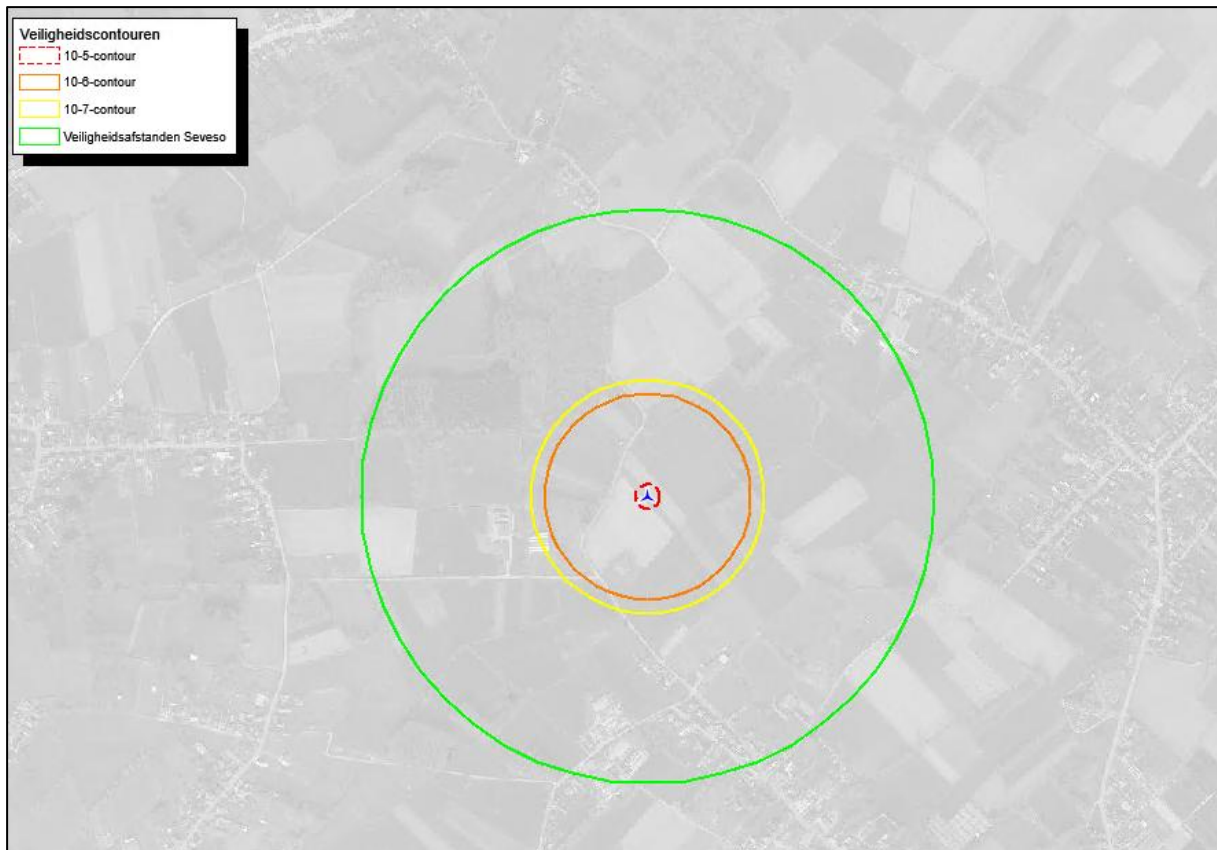
Figuur 22 : Voorbeeld veiligheidscontouren van 1 windturbine
