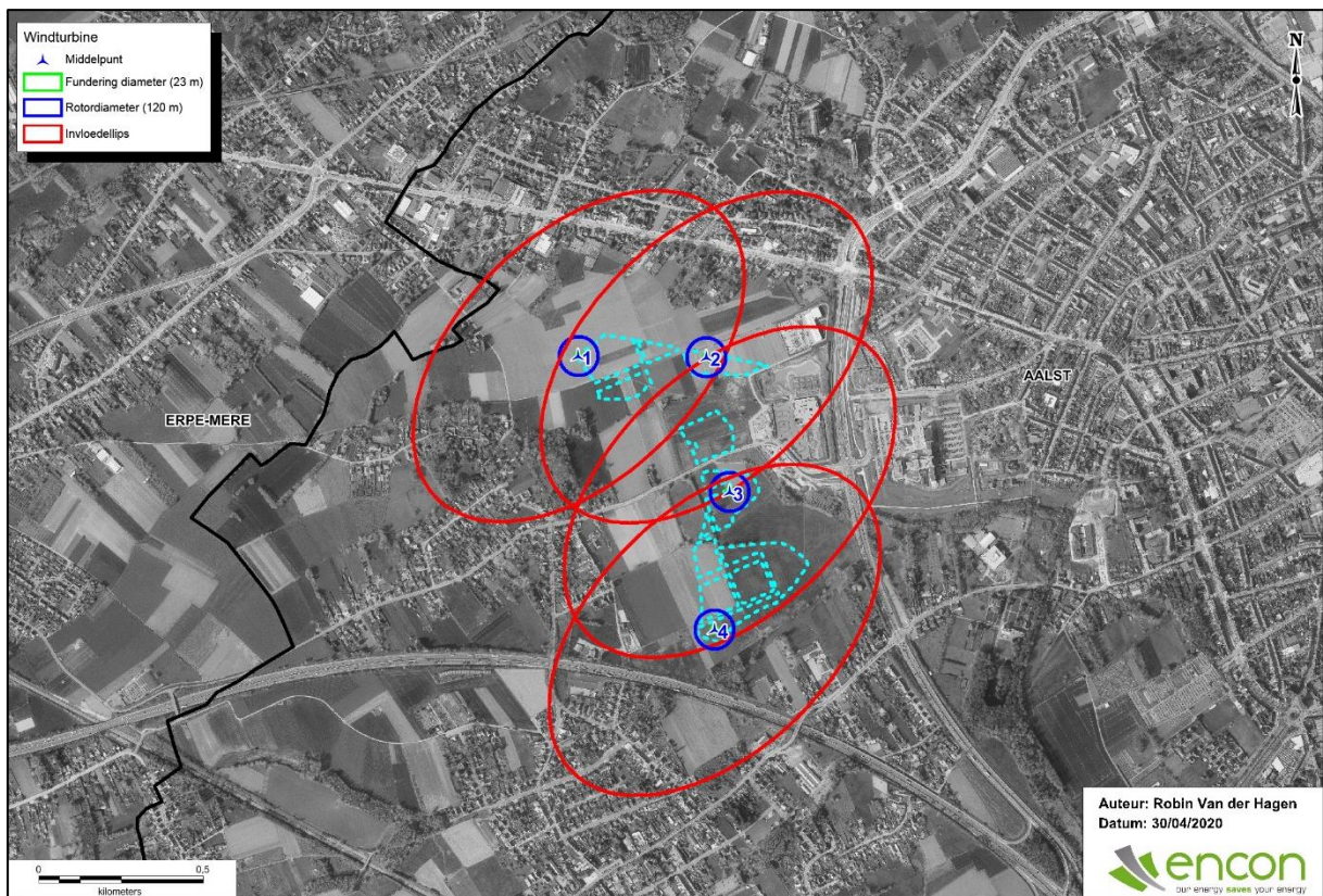
Figuur 49: Inplantingsplan Siesegem - Rotordiameter 120 m (bijlage 1)
