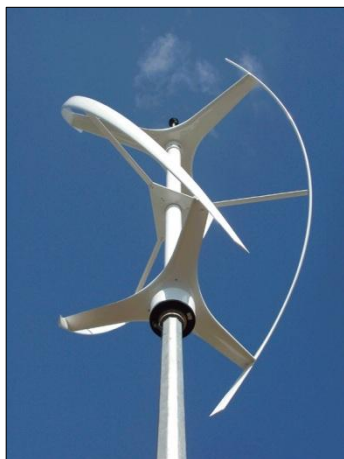
Figuur 3 : Darrieus-type verticale asturbine
