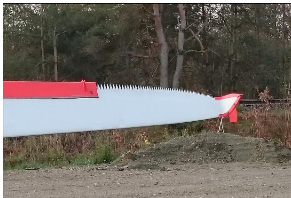
Figuur 19: Serrations op het uiteinde van de wiek
