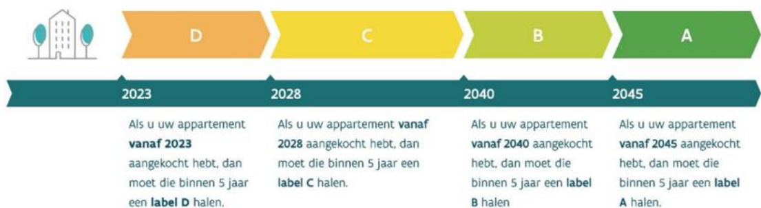
Figuur 21- verstrengingspad Vlaamse renovatieverplichting vóór 2025
