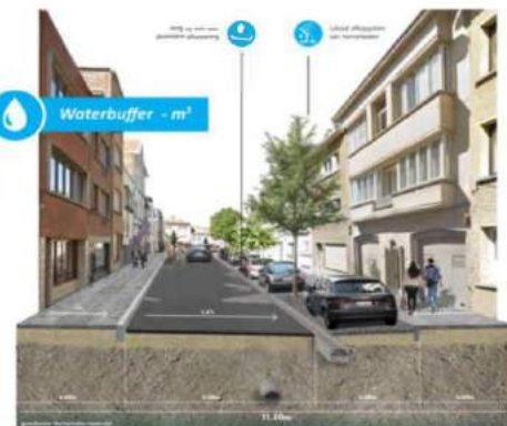
Uitgewerkte impressie technisch watertransporterende straat
