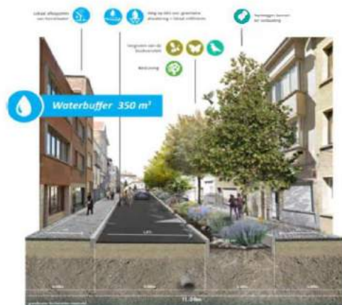
Uitgewerkte impressie Bioswale / groene watertransporterende straat
