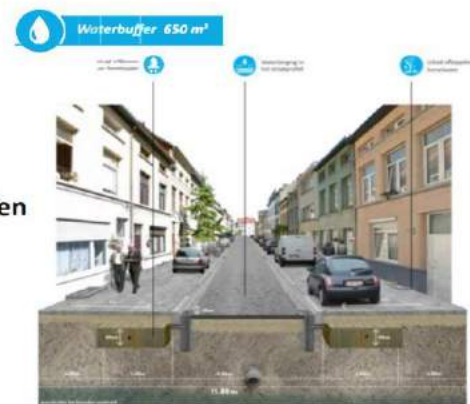
Uitgewerkte impressie technisch waterbergende straat
